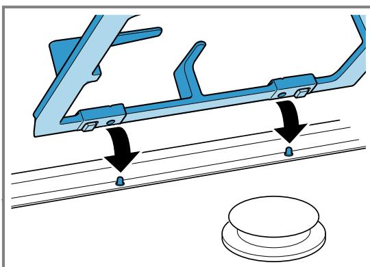
Așezați corect vasul de gătit grătare. Nu așezați niciodată vasul de gătit direct pe arzător.
